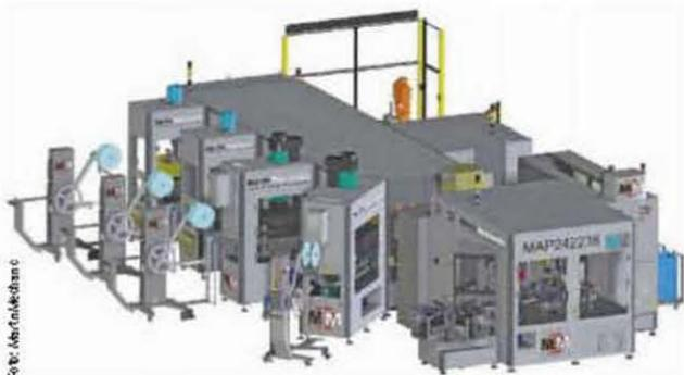
Neun Roboter sind in der neuen Arbeitszelle MAP242236 von MartinMechanic zum Umspritzen elektronischer Bauteile im Einsatz.
